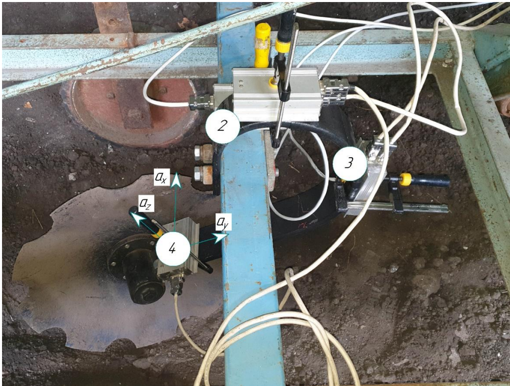
Рис. 2. Розташування датчиків на випробувальній установці: 1 – датчик тягового зусилля рами ( P_1 ); 2 – тензOMETричний датчик на стояку ( P_2 ); 3 – тензOMETричний датчик на стояку ( P_3 ); 4 – інерційний вимірювальний пристрій.
