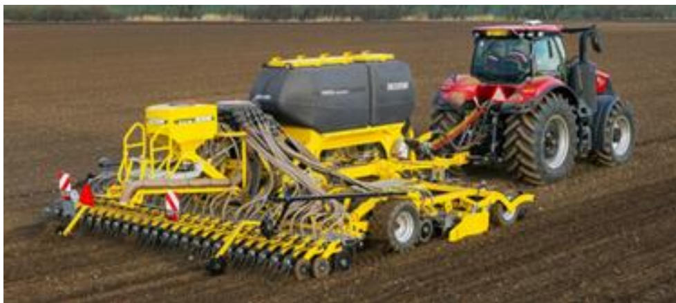
Рис. 8. Комбінована сівалка Omega OO FL
