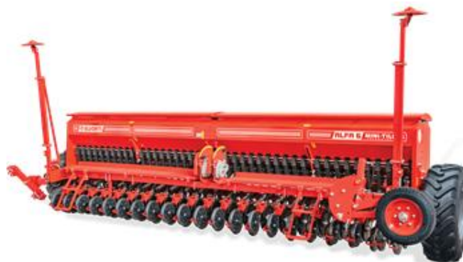
Рис. 5. Сівалка механічна зернова Alfa 6 Mini-Till
