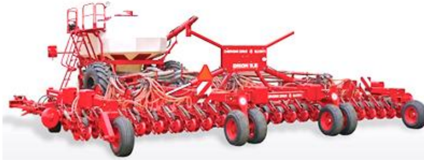
Рис. 4. Сівалка пневматична однодискова Orion 9,6
