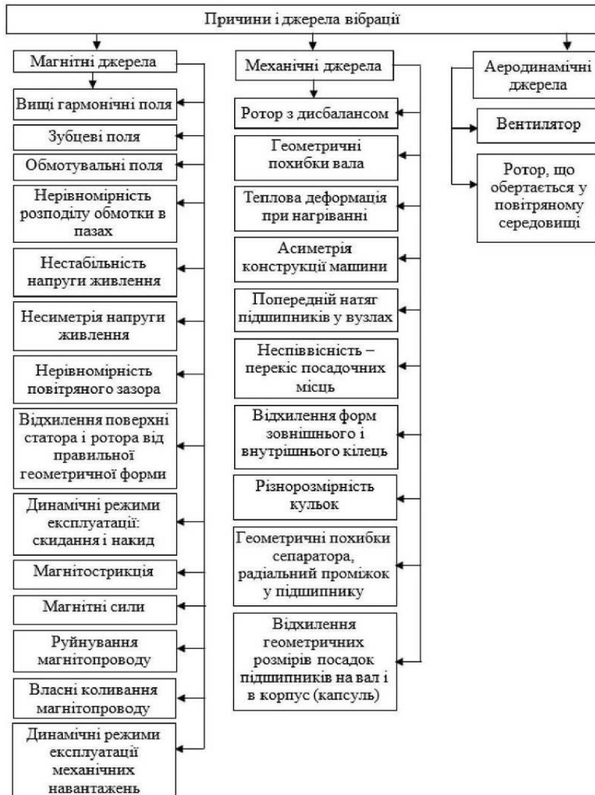
Рис. 3. Причини та джерела вібрації електромагнітного, механічного та аеродинамічного походження асинхронного електродвигуна
