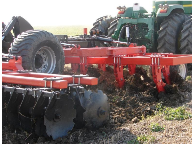
Рис. 2. Грунтообробний агрегат John Deere 9470R+ Gaspardo DIABLO-700.
