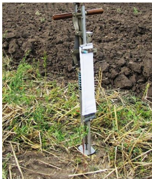
Рис. 1. Твердомір Рєвякіна для визначення твердості ґрунту.
