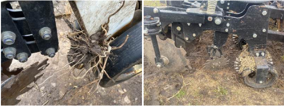
Рис. 1. Забивання між опорними колесами та рамою секції на якій закріплено култер. Агрегат: SLY StripCat та Yetter Maveric.
