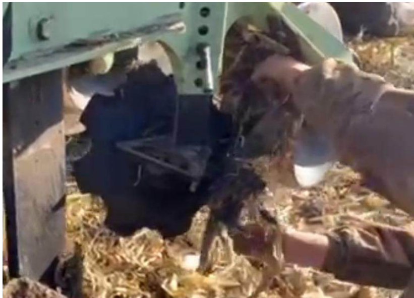
Рис. 2. Забивання між култером та очисником ряду агрегату Orthman 1TRPR.
