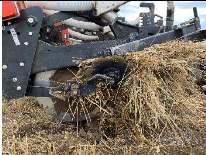
Рис. 3. Забивання перед лапою агрегату Kuhn Krause Gladiator.
