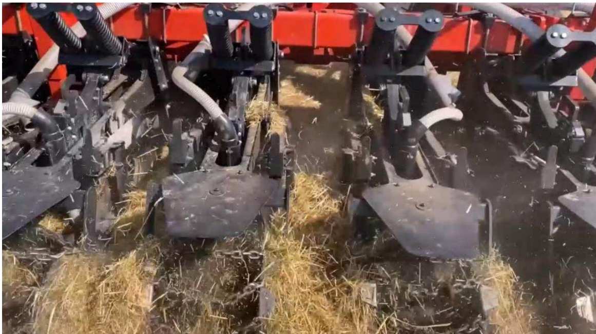
Рис. 6. Забивання між секціями.
