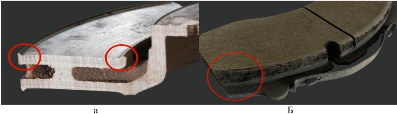
Рис. 1. Зношування гальмівної колодки та диска: а) борозди на диску; б) руйнування країв гальмівної колодки.
