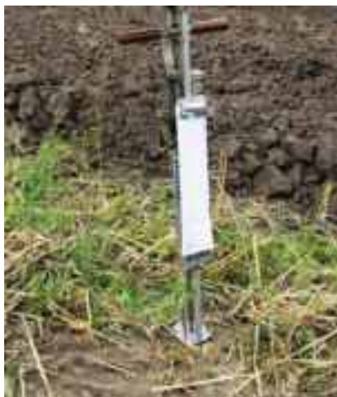
Рис. 1. Твердомір Ревякіна для визначення твердості ґрунту.
