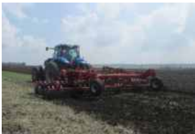
Рис. 1. Ґрунтообробний агрегат New Holland T8.390 + ДЛМ-8,0 під час випробувань
