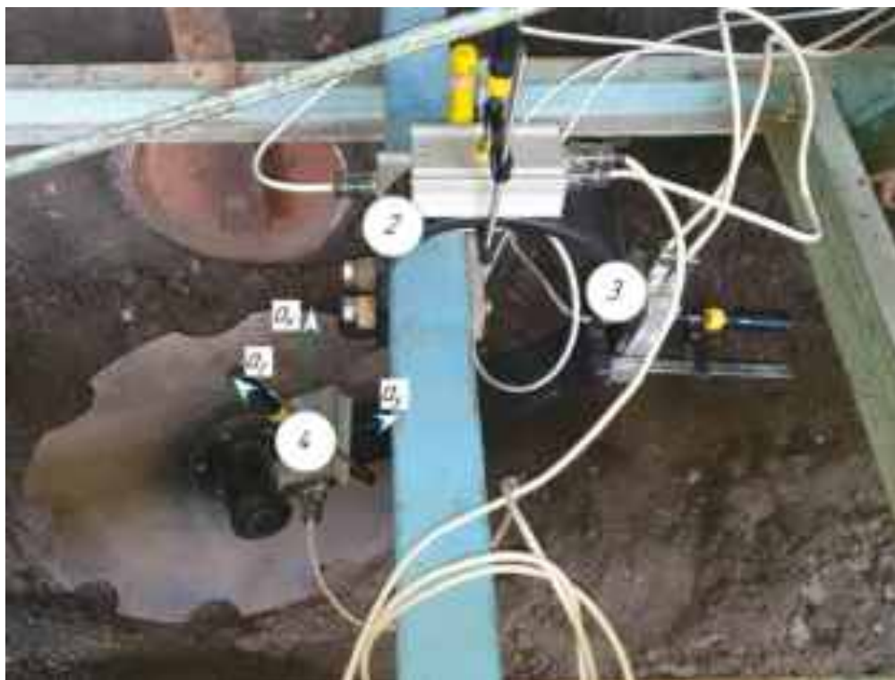
Рис. 2. Розташування датчиків на випробувальній установці: 1 – датчик тягового зусилля рами ( P_1 ); 2 – тензометричний датчик на стояку ( P_2 ); 3 – тензометричний датчик на стояку ( P_3 ); 4 – інерційний вимірювальний пристрій.
