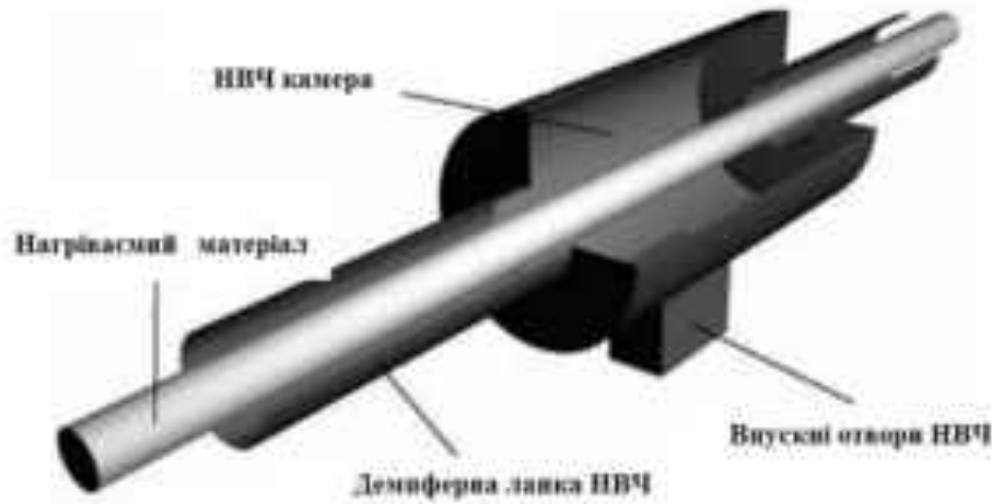
Рис. 4. Проточна конструкція НВЧ пристрою
