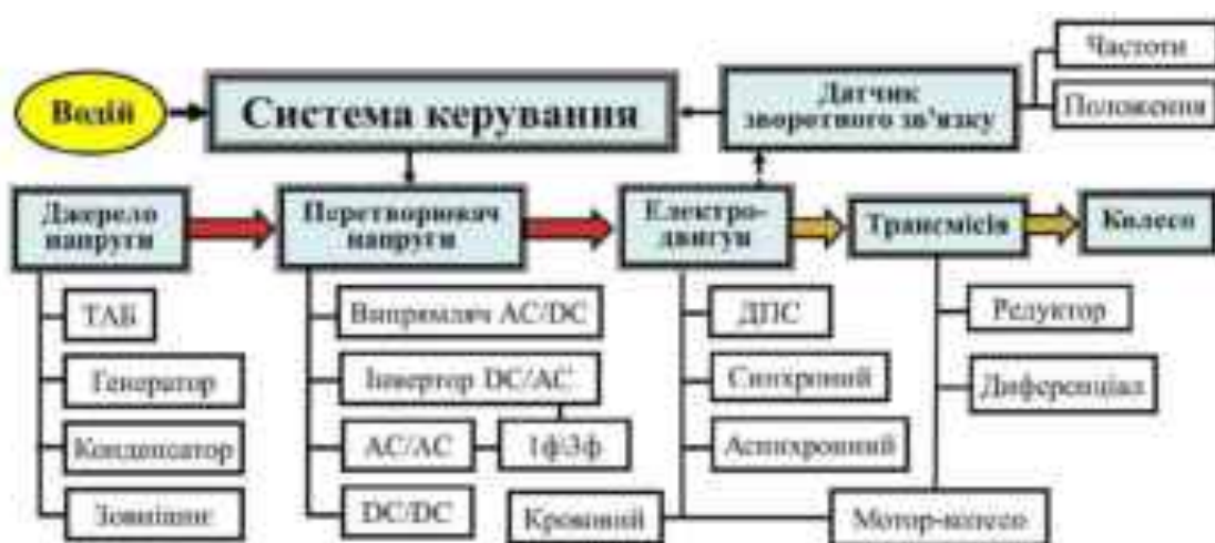
Рис. 1. Структурний склад електроприводу автомобіля
