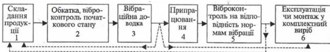
Рис. 4. Послідовність вібраційного контролю якості виготовлення трактора і його агрегатів
