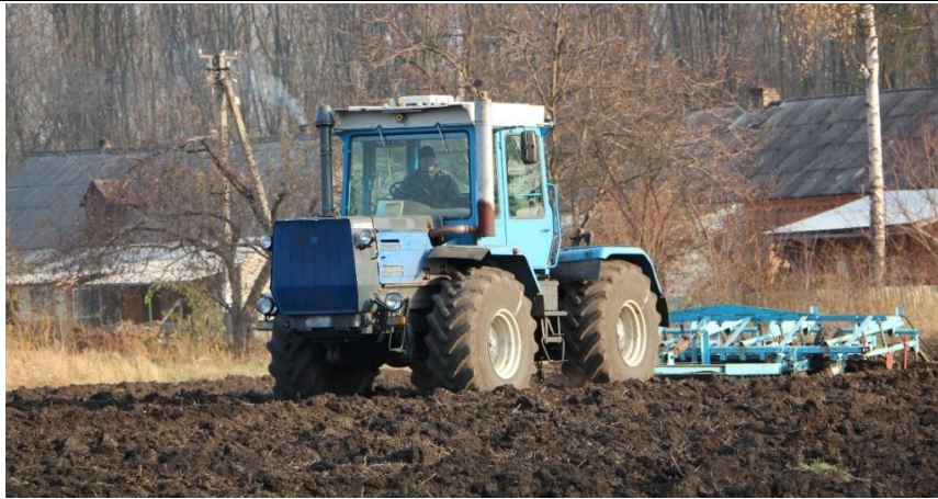
Рис. 1. Загальний вигляд ґрунтообробного агрегату у складі колісного трактора ХТЗ-17021 та культиватора КПС-4,2
