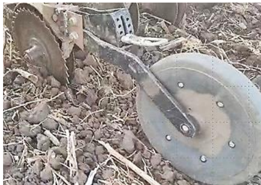
Рис. 4. Висів та заробка насіння експериментальним сошником з застосуванням прикочувального котка
