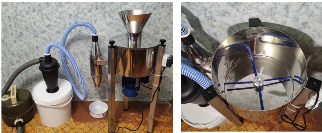
Рис. 10 – Лабораторний експериментальний комплекс, використаний для верифікації механічної моделі відокремлення гранул перги
